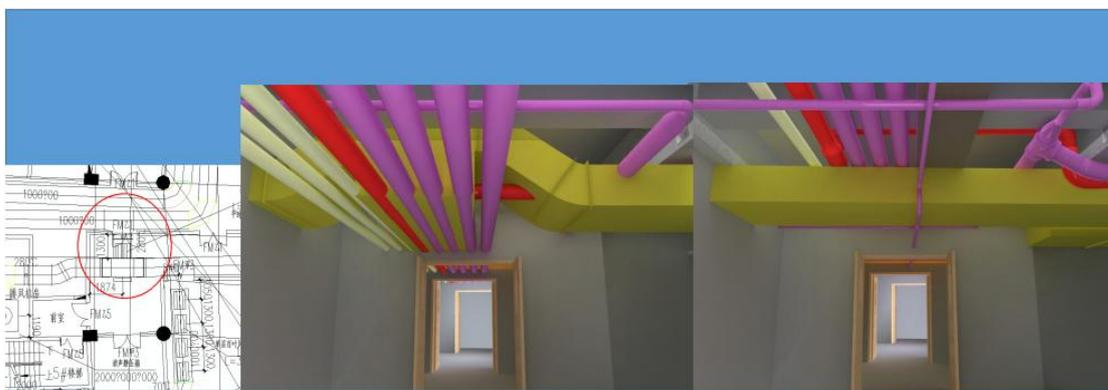
③净空优化：基于各专业模型，优化机电管线排布方案，对建筑物最终的竖向设计空间进行检测分析，并给出最优的净空高度。
